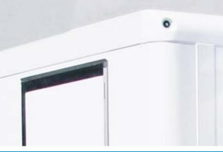
Stirnseitig versenkte LED-Umrissleuchten · Schutz gegen Anfahrschäden · Verbesserte Aerodynamik
